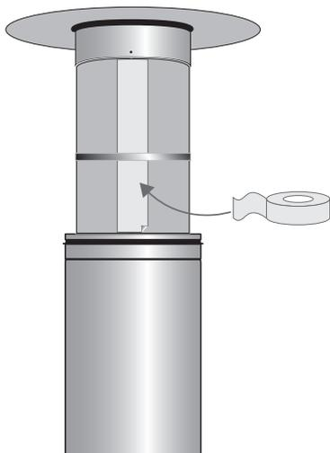
**SE** - Fäst isolering med de medföljande metallbuntbanden som skarvas hop. Tejpa sedan de långsgående skarvarna.
