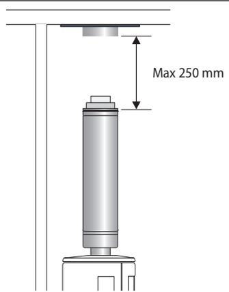
**SE** - Montera kopplingsstykke og bygg opp moduler från kaminen enligt monteringsanvisningen för skorstenen. Se till att det är ett mellomrum på max 250mm från skorstenen till där startseksjonen börjar. **NO** - Start med å montere startkobling på ildstedet, og bygg oppover fra kaminen som monteringsanvisningen for pipe viser. Se til at det er et mellomrom på max 25 cm fra pipe til der startseksjon for etasjeskille begynner.
