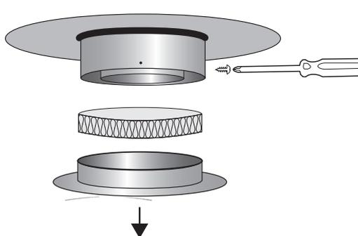
**SE** - Börja med att skruva bort de skruvar som hållit fast locket i startseksjonen. Avlägsna locket och den isoleringskiva som sitter inuti i locket.
